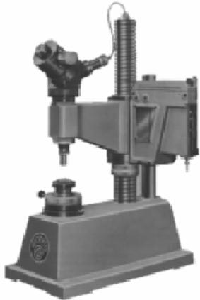
Máquina de micro dureza Vickers
