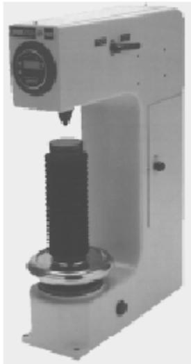
Máquina padrão de Dureza Rockwell
