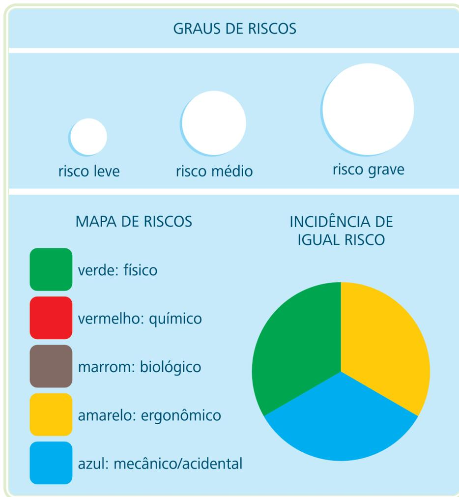
**Figura 4.1: Representação da gravidade e da cor correspondente a cada risco ambiental**
