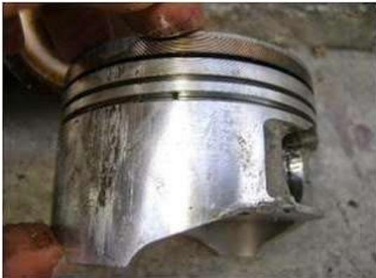
Exemplos de pistão com falha por lubrificação inadequada
