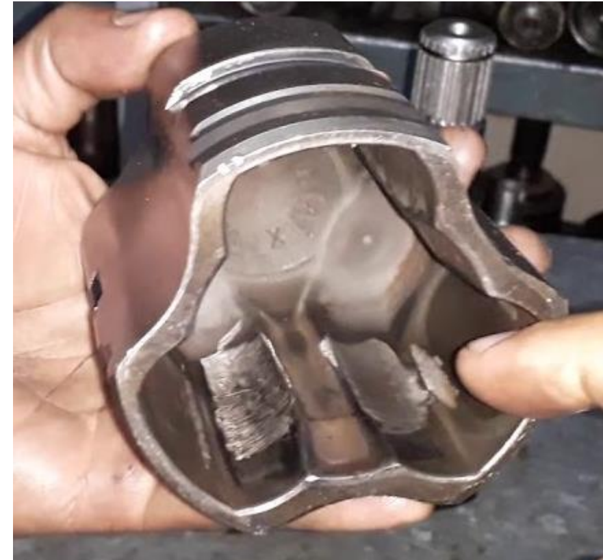
SEDE DA TULIPA CORROIDA
