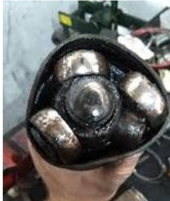
FALTA DE LUBRIFICAÇÃO
